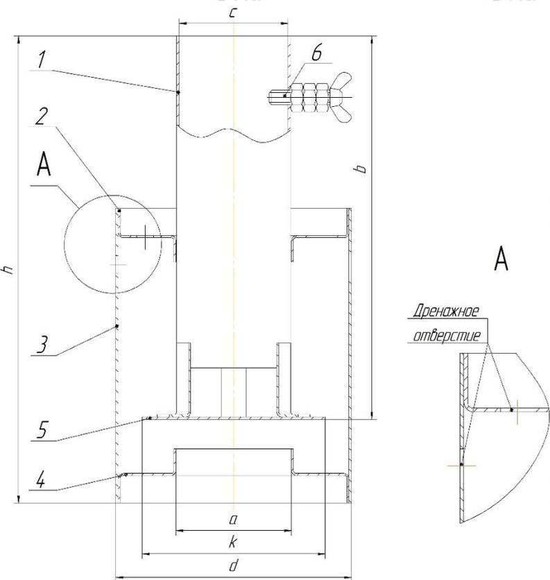
Рисунок 1. Наименование конструктивных элементов колонки
