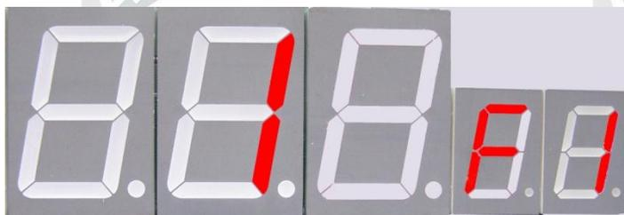
**2 F1** режим работы ТРК ручной (снять на ТРК раздаточный кран, набрать необходимое количество литров на клавиатуре ТРК, используя клавиши с цифрами, нажать клавишу «#» и подтвердить пуск красной кнопкой, через 4 сек включится насос ТРК).
