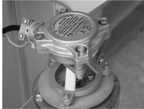
Рисунок В.1 – Схема пломбировки генератора импульсов, производства фирмы «Zhejiang Datian Machine Co., Ltd.» с измерителем объема СУГ
