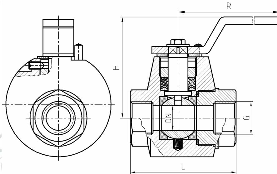
**КРАНЫ ШАРОВЫЕ – размеры в мм**
