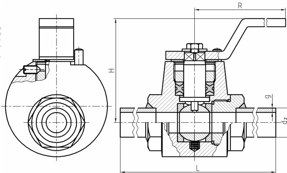
**КРАНЫ ШАРОВЫЕ – размеры в мм**
