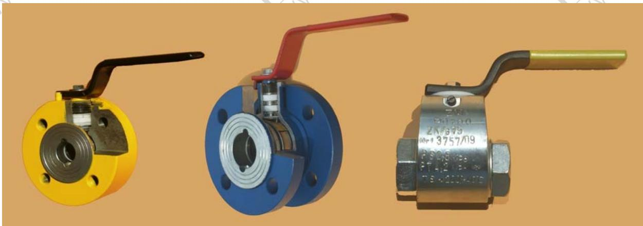
Техническая конструкция кранов является решением, обеспечивающим безопасность и их долговечное функционирование. Краны имеют полный проход (в открытом положении шар не мешает потоку вещества), а специальная система уплотнения штока предохраняет его выталкивание.
